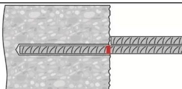
Beachten der Verarbeitungszeit  $t_{work}$  (siehe Tabelle B3), die je nach Untergrundtemperatur unterschiedlich sein kann. Während der Verarbeitungszeit ist ein geringfügiges Ausrichten des Betonstahls möglich.
