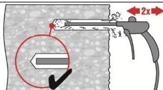
Bohrloch 2-mal vom Bohrlochgrund über die gesamte Länge mit ölfreier Druckluft (min. 6 bar bei 6 m³/h; falls notwendig mit Verlängerung) ausblasen, bis die rückströmende Luft staubfrei ist.
