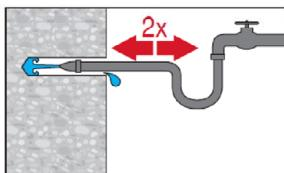
Das Bohrloch 2 mal mittels Wasser mit einem Schlauch vom Bohrlochgrund spülen, bis klares Wasser aus dem Bohrloch austritt. Normaler Wasserleitungsdruck genügt.
