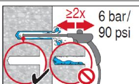
Bohrloch 2-mal vom Bohrlochgrund über die gesamte Länge mit ölfreier Druckluft (min. 6 bar bei 6m<sup>3</sup>/h; falls notwendig mit Verlängerung) ausblasen, bis die rückströmende Luft staubfrei und das Bohrloch trocken ist.
