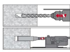
Die Bohrlocherstellung bis zur erforderlichen Setztiefe erfolgt drehschlagend mithilfe eines Bohrhammers, mithilfe eines Pressluftbohrers oder mithilfe eines Diamantkernbohrers unter Verwendung des passenden Bohrerdurchmessers.
