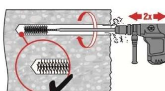
Die Rundbürste HIT-RB auf Verlängerung(en) HIT-RBS aufzuschrauben, so dass die Gesamtlänge ausreichend ist um das Bohrlochende zu erreichen. Das andere Ende der Verlängerung im Bohrfutter TE-C/TE-Y befestigen.
