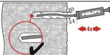
Für Bohrlochdurchmesser  $d_0 \leq 20$  mm und Bohrlochtiefen  $h_{\text{ef}} \leq 10 \cdot d$  kann die Hilti Handausblaspumpe verwendet werden.
