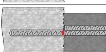
Eine Belastung des Bewehrungsanschlusses darf erst nach Ablauf der Aushärtezeit  $t_{cure}$  erfolgen (siehe Tabelle B3).
