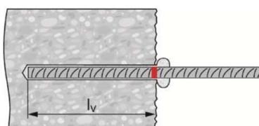
Nach dem Setzen des Betonstahls muss der Ringspalt vollständig mit Mörtel ausgefüllt sein.
