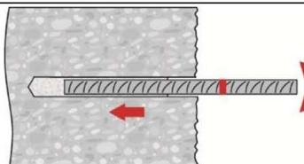
Zur Erleichterung der Installation den Betonstahl drehend in das verfüllte Bohrloch bis zur Setztiefenmarkierung einführen.
