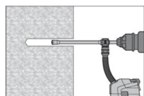
Die Bohrlocherstellung bis zur erforderlichen Setztiefe erfolgt drehschlagend mit einem Hilti Hohlbohrer TE-CD oder TE-YD in Kombination mit einem Hilti Staubsauger VC 20/40 (-Y) (Saugvolumen  $\geq 57$  l/s) bei dem die automatische Filterreinigung aktiviert ist. Dieses Bohrsystem beseitigt bei Anwendung gemäß der Gebrauchsanweisung des Hohlbohrers das Bohrmehl und reinigt das Bohrloch während des Bohrvorgangs.
