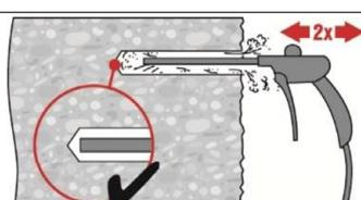
Bohrloch erneut vom Bohrlochgrund über die gesamte Länge 2-mal mit Druckluft ausblasen, bis die rückströmende Luft staubfrei ist.
