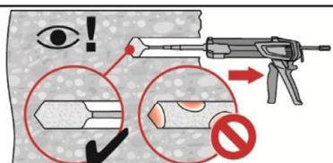
Injizieren des Mörtels vom Bohrlochgrund und während jedem Hub den Mischer langsam etwas herausziehen.
