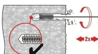
2-mal mit Stahlbürste in passender Größe (siehe Tabelle B4) bürsten. Stahlbürste Hilti HIT-RB mit einer Drehbewegung in das Bohrloch bis zum Bohrlochgrund einführen und wieder herausziehen (falls notwendig mit Verlängerung).
